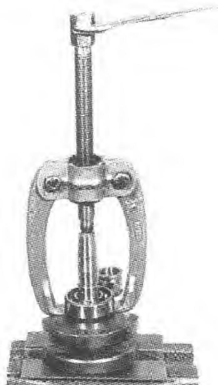
Sl. 90 — Skidanje kugličnog ležaja sa radilice
